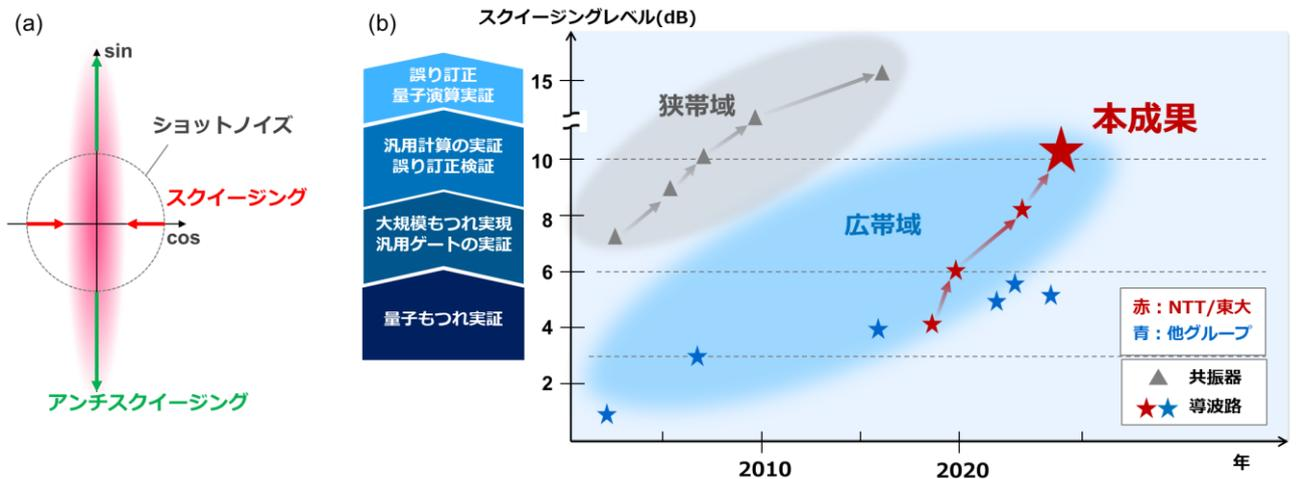
図 1 (a) スクイズド光の量子ノイズ (b) 導波路型デバイスによるスクイーミングレベルの変遷 (広帯域性を発揮する導波路型光デバイスでの高スクイーミングレベルが近年求められている)
