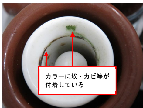
（図 3）固定モールドの汚損例
