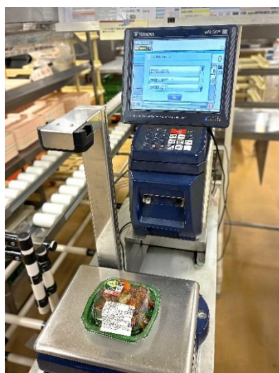
（左）「Itemiq」を搭載した 計量値付機「DPS-560 II」 （上）品番呼び出し後の画面イメージ
