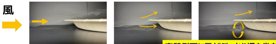
容器側面に風がぶつかり渦を巻き、皿が浮き上がる
