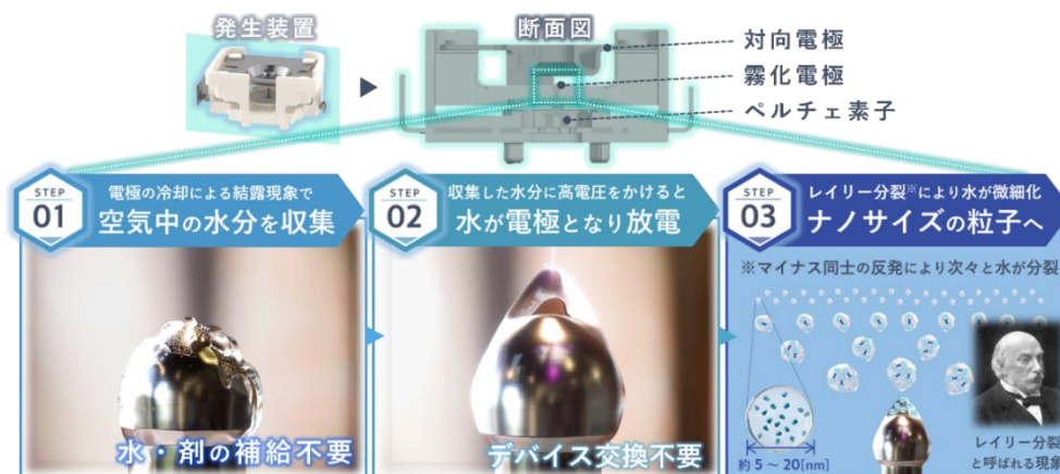
図 3. ナノイー(帯電微粒子水)発生装置
