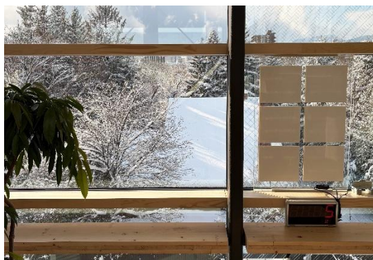
＜屋内側から窓ガラスに設置された ペロブスカイト太陽電池＞
