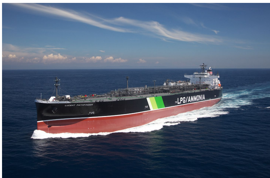
LPG 燃料推進 LPG/アンモニア運搬船「LUCENT PATHFINDER」
