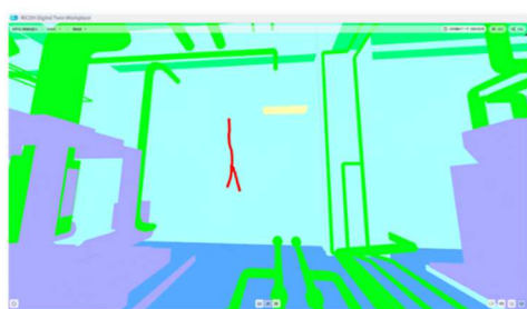
ひび割れスケッチを自動配置した建物の3次元モデル (※画像はイメージです)
