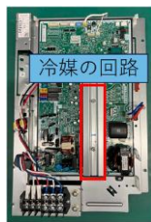
図⑧：プリント基板を冷やす冷媒の回路
