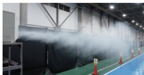
図②：気流が 20m 先まで到達している様子
