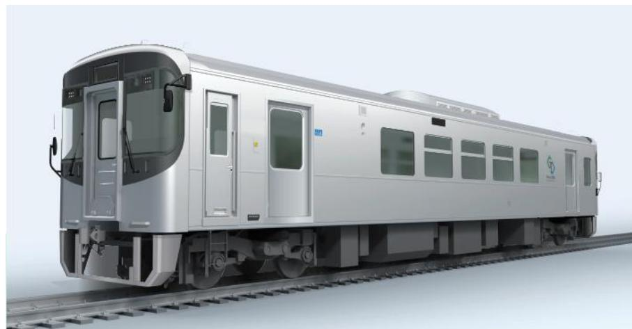
また、「GreenDEC®」のデザインは、シンプルに、時代を超えて使い続けられる普遍性をコンセプトとしています。外観は、車両外板の素地を生かしたステンレスの地肌をそのままに見せ、クリーンなイメージにしつつ、車両前面部分をブラックフェース化することで、引き締まったイメージも追求しています。車両のブランドを表すロゴを配して、車両自身のアイデンティティーも形成しています。
