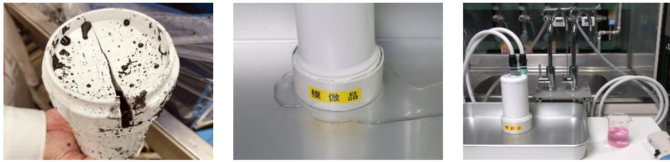
左：破裂して活性炭が出てきた非純正品 中：模倣品の水漏れ実験 右：模倣品の残留塩素実験
