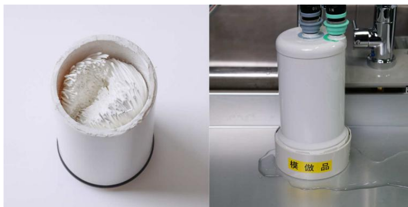
膜の切れたフィルター
