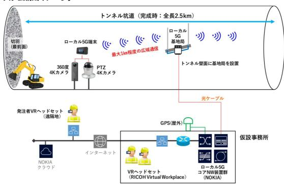
切羽付近に設置された 4K 対応 360 度力メラの映像をトンネル内のローカル 5G 無線を通じて現場の 仮設事務所に伝送することにより、その場からリアルタイムで施工状況を自由な視点にて確認すること が可能になります。
