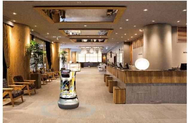
「Relay」は Saviok(サビオク), Inc (所在地：米国カリフォルニア州) が開発した自律走行型デリバリーロボットで、障害物を回避しながら自動走行し、エレベーターにも自動搭乗して客室のドア前まで到達することができます。従来、従業員からお客様へ直接モノを届けるスタイルが一般的であったホテルのデリバリーサービスが、「Relay」により利便性と効率性の高い次世代型のサービス提供を実現します。ホテル内でのサービスを可能とするために、株式会社マクニカ(所在地：神奈川県横浜市、代表取締役社長：中島 潔) がエレベーターシステム等ホテル設備とのインテグレーションを担当することでサービス実施の運びとなりました。
