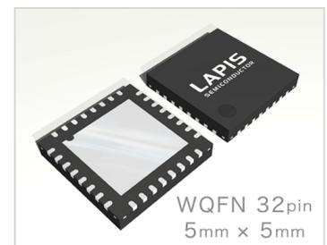
ML7404は、業界で初めてLPWAデュアルモード対応を実現した無線通信 LSIです。免許不要のSubGHz帯域を用いたLPWAのなかでも、世界30カ国以上で採用が進み、国内でも首都圏を中心に展開され始めた「SIGFOX」の無線方式に対応すると同時に、同一システムの妨害波耐性が高く、より多くの端末をネットワーク傘下に収容できる特長をもつ国際標準規格「IEEE802.15.4k<sup>注1</sup>」無線方式にも対応しました。この業界初デュアルモード対応によって、適用範囲の広いLPWAゲートウェイなど幅広い用途・仕様での活用を可能にしています。
